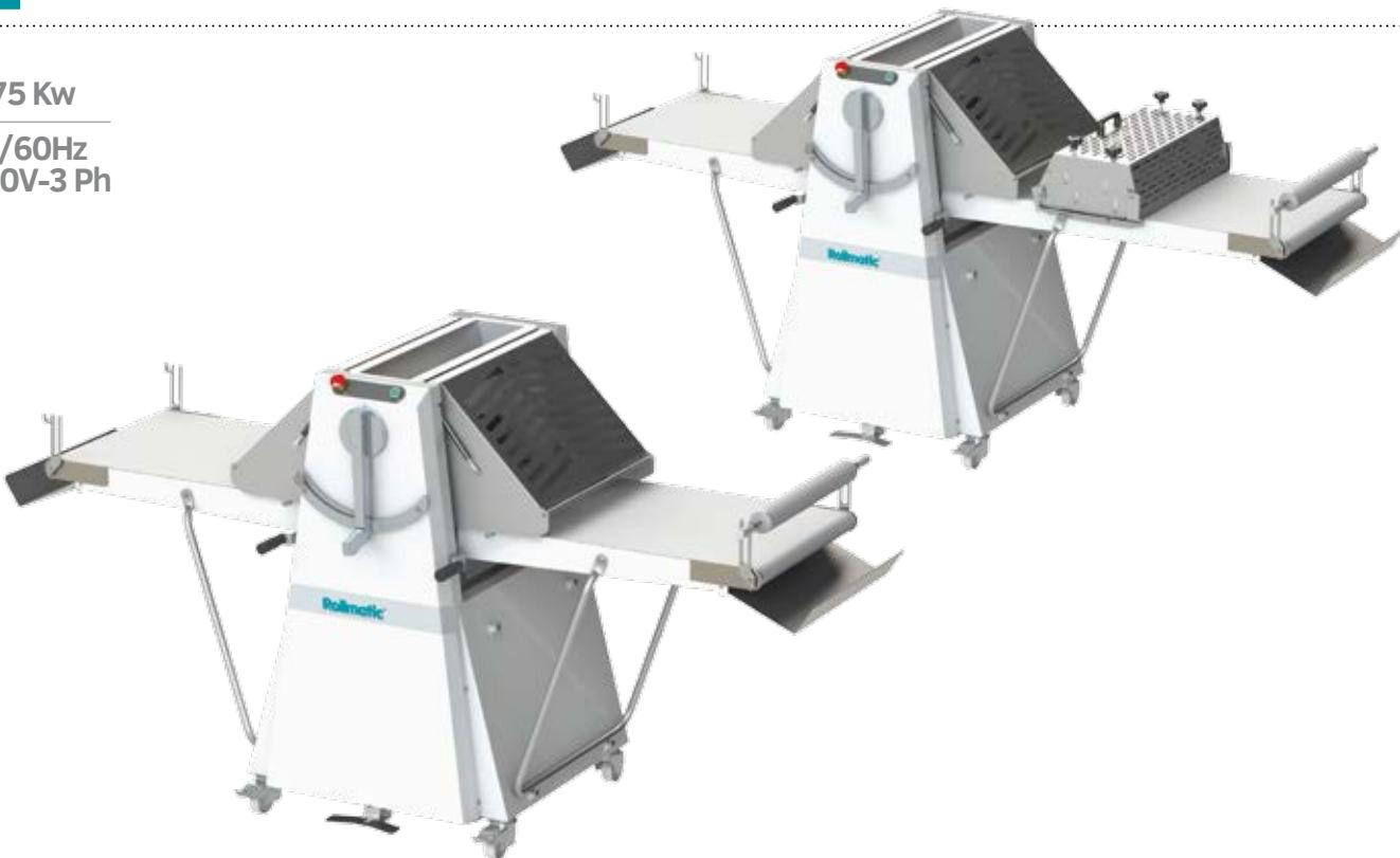
Sfogliatrice manuale su base con ruote. Tavoli ripiegabili ed estraibili. Inversione del ciclo di lavoro con barra e pedaliera, protezioni dei cilindri in inox con micro di sicurezza e molla a gas. Disponibile in versione con 2 velocità(o inverter) e box di taglio. Lettura digitale dell'apertura dei cilindri(opzionale)
