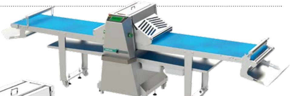
Sfogliatrice su base con ruote, in acciaio inox e totalmente automatica, disponibile anche in versione con sistema di taglio incorporato (R65AX-T). Sfarinatore e avvolgitore automatici. Tavoli ripiegabili ed estraibili. Touch screen da 7" con 100 programmi di lavoro. Protezioni dei cilindri con micro di sicurezza e molla a gas. Sistema rapido di tensionatura e sgancio dei tappeti. Raschiatori con rilascio rapido QR(Quick Release - brevetto Rollmatic). Cassetto farina con micro di sicurezza
