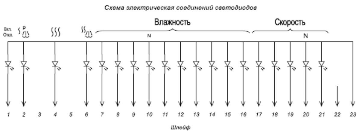
Рис. 13. Схема пленочной клавиатуры.
