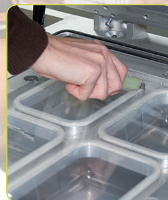
Fustellatura manuale delle vaschette Manual trays cutting
